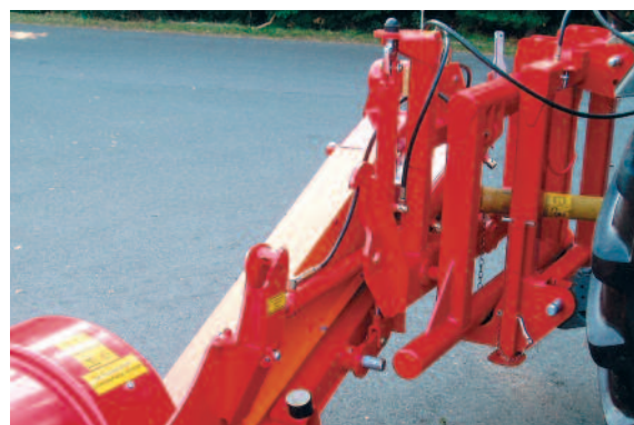
hydraulisk transportsikring i arbejdsstilling
