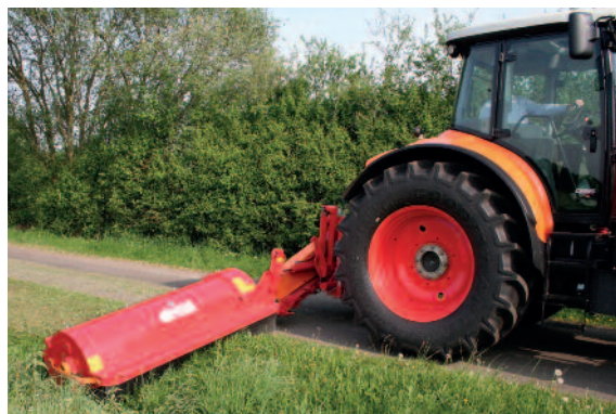
USM 18 til klipning af dæmninger
