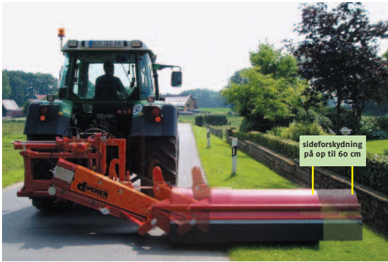
USM 18 med hydraulisk sideforskydning
